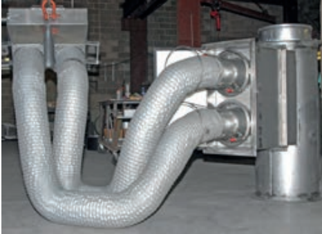
Base de tubo de evacuación con manguera para tanque M1
